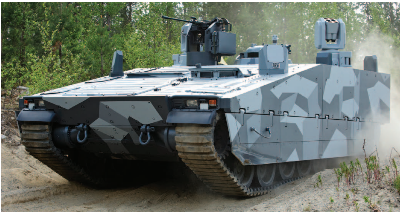
Platforma ARMADILLO. Produkowana seryjnie uniwersalna platforma III generacji, rodziny CV-90 o nazwie ARMADILLO, opancerzonych pojazdów gąsienicowych. Platforma jest bazą dla 12 konfiguracji pojazdów specjalistycznych przystosowanych do 14 wersji uzbrojenia. Dochodzenie do III generacji rodziny pojazdów od podjęcia projektu do stanu gotowości operacyjnej trwa od 10 do 13 lat. Nakłady w granicach 200 mln EUR
