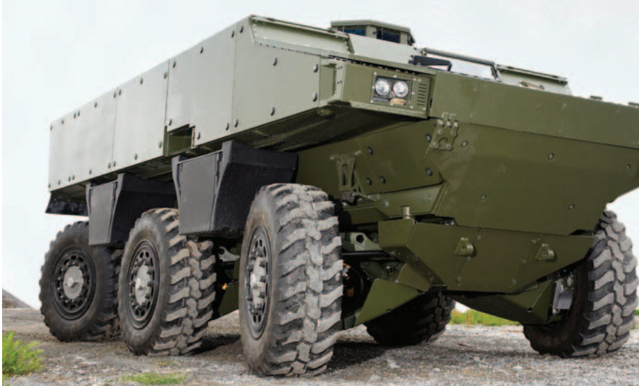
Platformy IV/V generacji. Dwa studyjne prototypy zunifikowanej platformy kołowo-gąsienicowej o napędzie hybrydowym. Prototypy te mają być podstawą do zunifikowanych platform bazowych, kołowych i gąsienicowych rodziny CV IV/V generacji. Czas na doprowadzenie prototypów do aktualnego stanu przedprodukcyjnego około 10 lat. Producent nie ujawnia poniesionych nakładów.
