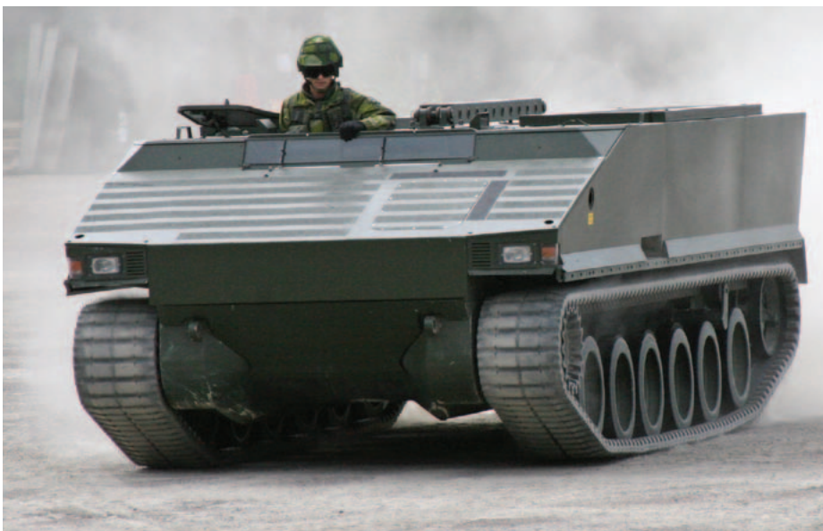
Platformy IV/V generacji. Dwa studyjne prototypy zunifikowanej platformy kołowo-gąsienicowej o napędzie hybrydowym. Prototypy te mają być podstawą do zunifikowanych platform bazowych, kołowych i gąsienicowych rodziny CV IV/V generacji. Czas na doprowadzenie prototypów do aktualnego stanu przedprodukcyjnego około 10 lat. Producent nie ujawnia poniesionych nakładów.
